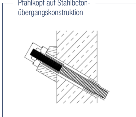
Pfahlkopf auf Stahlüber- gangskonstruktion
